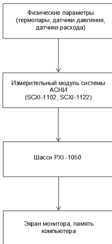
Рисунок 7 – Принципиальная схема системы сбора и обработки информации для установки
